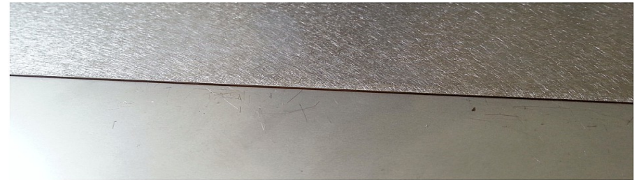
Die Oberflächen in geschliffenem und unbehandeltem Zustand
